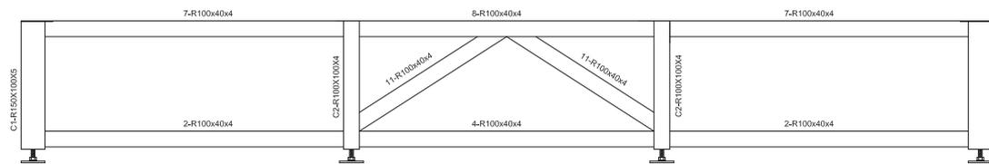
SOTTOSTRUTTURA TIPO A TELAIO T3
