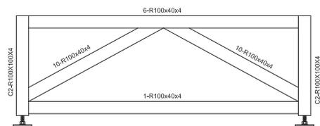
SOTTOSTRUTTURA TIPO A TELAIO T2
