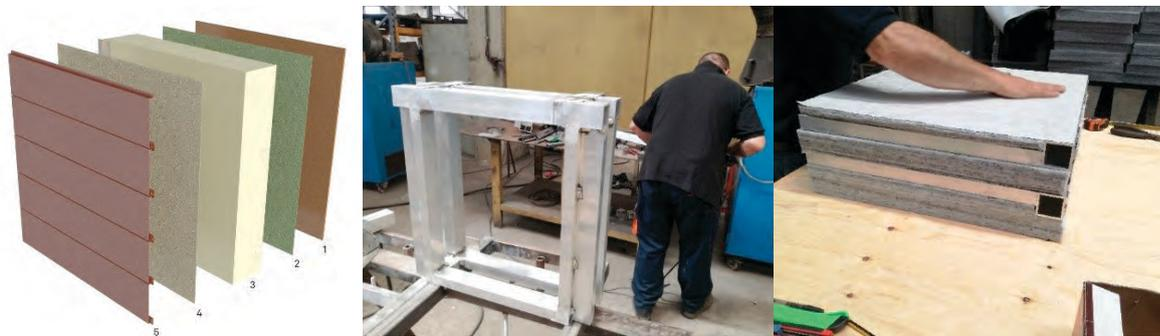
Figura 11 Frontiera: 1. Rivestimento interno (es. pannelli in legno di abete), 2. Barriera al vapore, 3. Isolante termoacustico in fibre di poliestere riciclato su telai in alluminio, 4. Barriera antivento, 5. Rivestimento esterno (es. doghe scatolari in alluminio verniciato). Progetto e montaggio prototipo per testing in officine De Masi (C.Nava, R.Astorino, A.Procopio, 2017).
